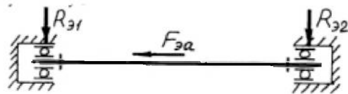
Рис 9.3 Расчетная схема нагружения шариковых подшипников
